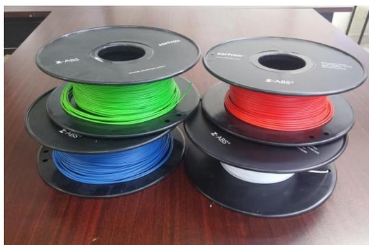
Il miglior materiale da utilizzare per le sperimentazioni è la plastica polimerica: **PLA** e **ABS**. Sono entrambe termoplastiche ovvero materiali che possono essere scaldati e sciolti, continuamente e ripetutamente. Entrambe sono disponibili in una vasta gamma di colori, elemento che migliora la qualità complessiva dell'oggetto da stampare.
