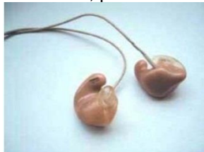
Figura 5. Monitor intrauricolari personalizzati (Fonte: Linee guida europee [1]).
