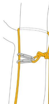
Fig. 3 - Possibile variante dello strozzo diretto della fune
