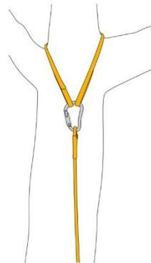
Fig. 5 - Ancoraggio della fune con dispositivo passante
